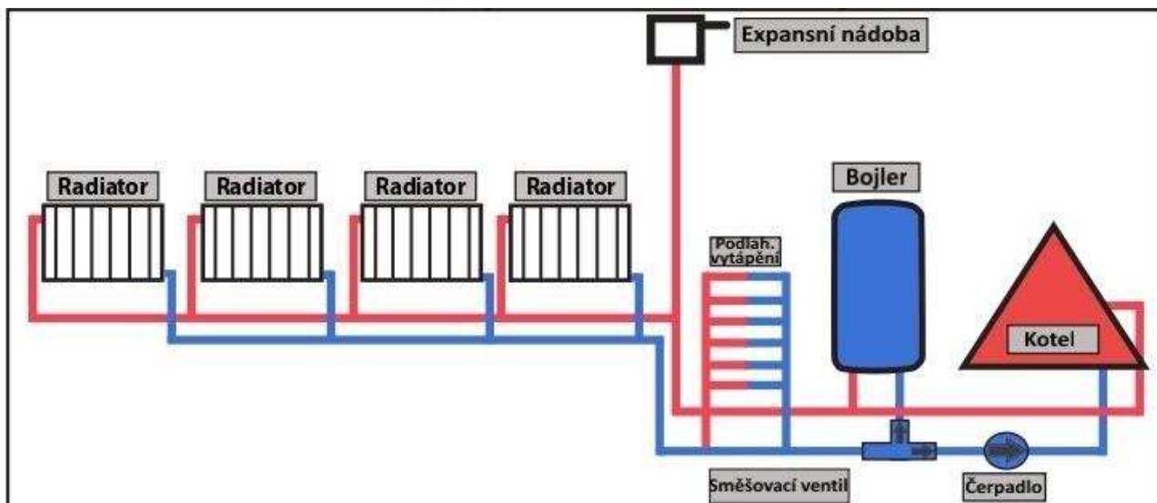
Příklad schématu instalace antikondenzačního ventilu. Doporučuje se, aby byl ventil dimenzován pro teplotu alespoň 50°C. Podle uvážení instalatéra může být použit ventil s vyšší teplotou zpětné vody.
