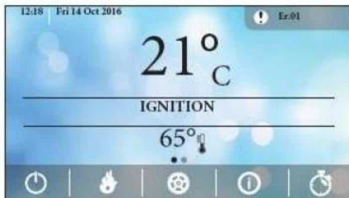
Ne/blokující chyba je zvýrazněna vykřičníkem a souvisejícím kódem. Po stisknutí se otevře chybové okno.
